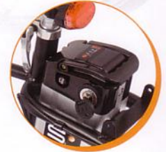
Batterie extractible avec clé anti-vol
